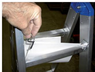
2. Drahtbügel über die oberen beiden Leitersprossen drücken
