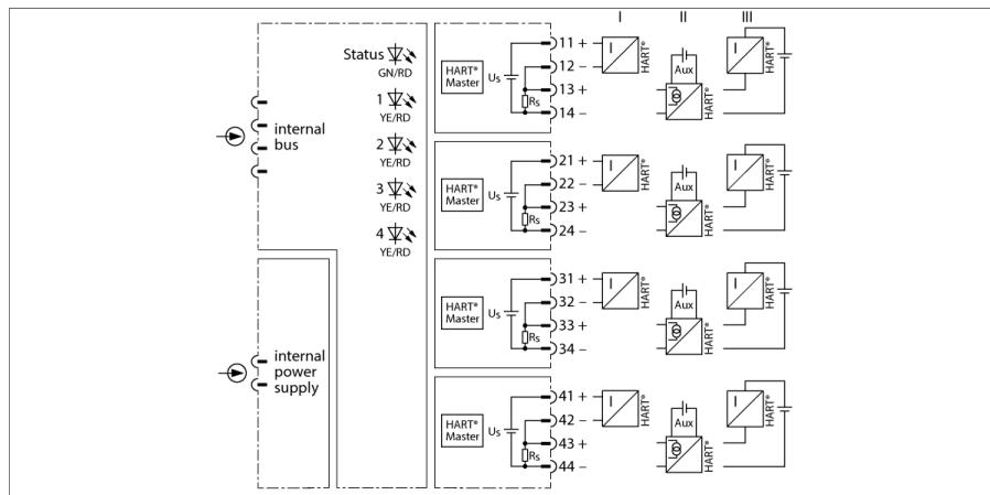
Das Eingangsmodul AIH401-N dient zum Anschluss von aktiven und/oder passiven 2-Leiter-Messumformern.
