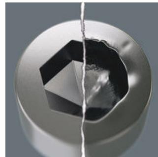
Innensechskantschrauben sind problematisch, denn die Anlageflächen, über die die Kraft vom Werkzeug auf die Schraube übertragen wird, sind sehr schmal. Die Folge: Der Schraubekopf kann zerstört werden. Hex-Plus Werkzeuge haben größere Anlageflächen, die diese Gefahr verringern. Gut zu wissen: Hex-Plus Werkzeuge passen in jede Standard-Innensechskantschraube!
