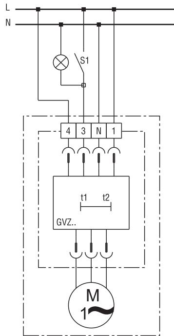
Ventilator läuft immer in Grundlast. Bei Raumbenutzung ( $S1=Ein$ ) schaltet der Ventilator nach ca. 50 s selbsttätig auf Volllast um.
