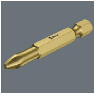
TH-Bits sind extraharte Bits mit Torsionszone. Torsion-Bits sorgen für die Abfederung von Drehmomentspitzen in der Torsionszone. Dadurch wird vorzeitiger Verschleiß vermieden, die Lebensdauer des Bits wird erhöht.
