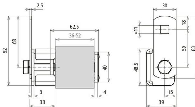
Durchdringung von Oberflächenbeschichtungen bis 0,2mm mit Klinge oder Klinge und Schraube.
