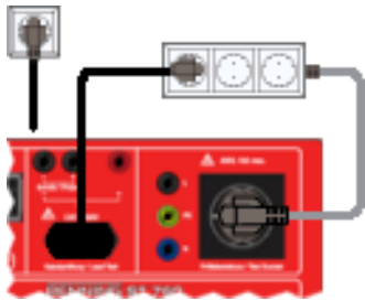
Anschlussschema VDE 0701; VDE 0702
