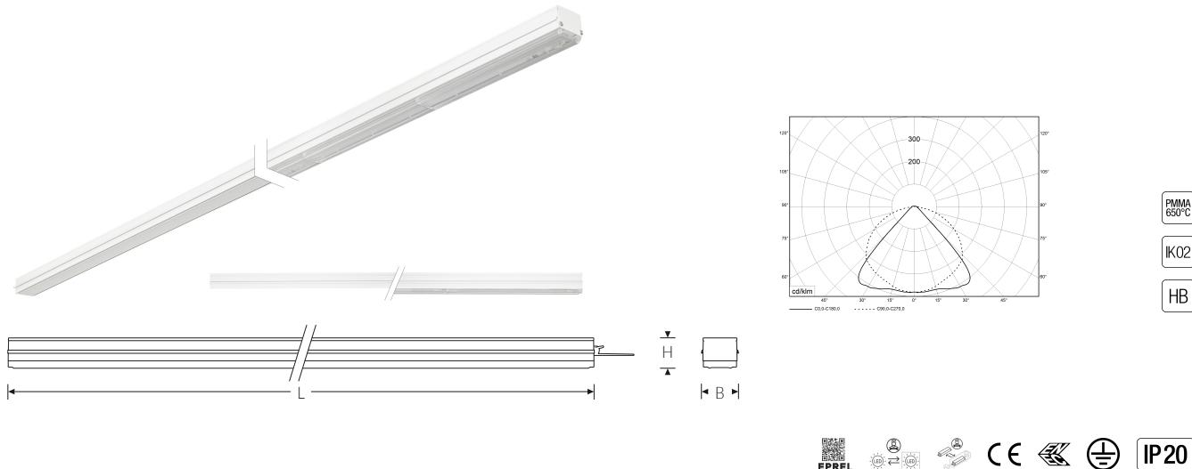
TRF LED-Lichtleiste mit einreihiger, linearer Lichtoptik aus PMMA. Wide Beam, 90° Abstrahlwinkel. Tragschiene und Lichteinsatz sind eine Einheit. Gehäuse aus profiliertem Aluminium. Mit Schnellverschluss, ohne Durchgangsverdrahtung. Mit montiertem Enddeckel. Verwendbar als Einzelleuchte oder als Endmodul im Lichtband.
