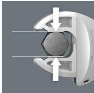
Die parallelen glatten Backen des 7880 Joker ermöglichen eine Flächenpressung und können dadurch das Verrunden der Mutter bzw. des Schraubenkopfes vermeiden, was bei der Kraftübertragung über Ecken auftreten kann.
