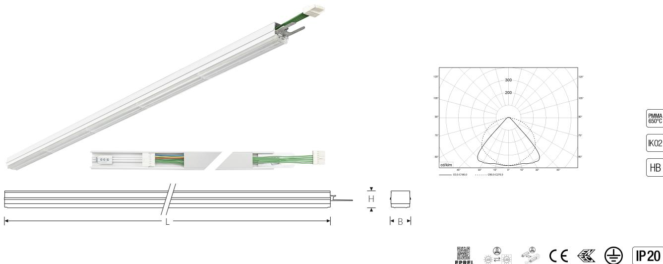
TRF LED-Lichtleiste mit einreihiger, linearer Lichtoptik aus PMMA, dimmbar. Wide Beam, 90° Abstrahlwinkel. Tragschiene und Lichteinsatz sind eine Einheit. Gehäuse aus profiliertem Aluminium mit Durchgangsverdrahtung, Stecksystem und Schnellverschlüssen.
