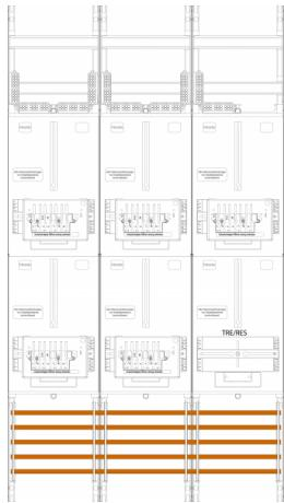
**Zählerfeld Z216ZR6-ZSK, 3-feldrig, H=1350mm, 5-3.HZ,
