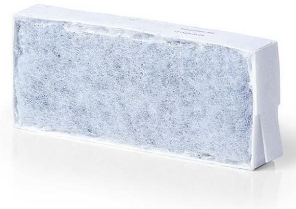
Original-Ersatzfilter für dezentrale Wohnraumlüftungsgeräte WRL-K75 und WRL-K90 Typ: WRL-KFA, G3 "Aktivkohle", Filterklasse G3 (DIN 779:2012), bzw. ISO coarse 50% (ISO16890), Rahmen aus PET, Filtermedium PP plissiert, mit Auszugslasche, für Außenluft, (nur bedingt geeignet), Abmessung: 151x65x25mm
