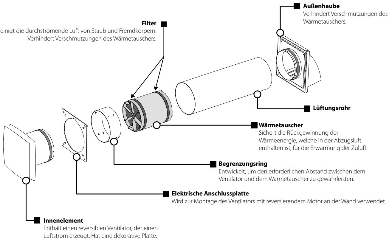
Die Lüftungsanlage funktioniert in zwei Zyklen, je 60 Sekunden.
