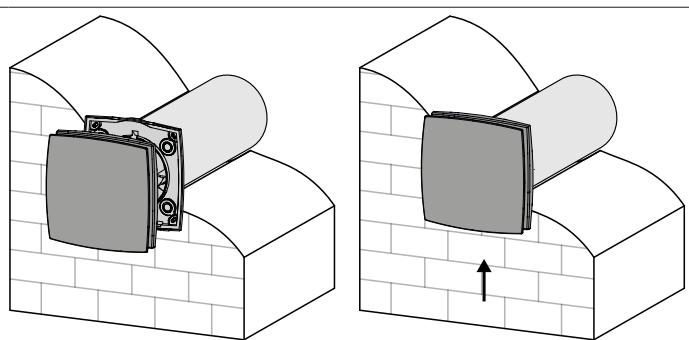
7. Montieren Sie die Außen-Lüftungshaube oder das Gitter.
