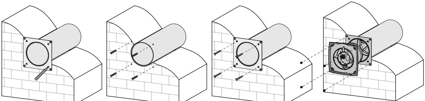
6. Bringen Sie die Vorderseite des Innenelements an seiner Originalposition an und befestigen Sie es mit einer Schraube mit einem Schraubenzieher.
