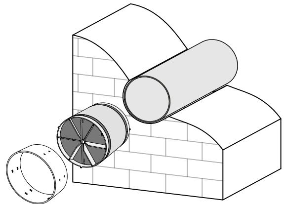
4. Lösen Sie mit einem Schraubenzieher die selbstschneidende Schraube aus dem Gehäuse und entfernen Sie die Vorderseite des Innenelements.
