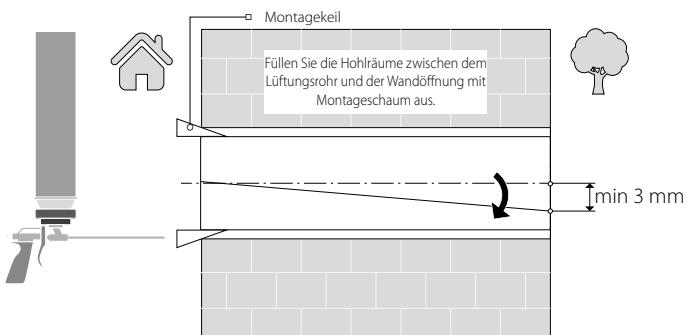
Das Lüftungsrohr mit einem Mindestwinkel von 3 mm an der Außenseite nach unten einsetzen.
