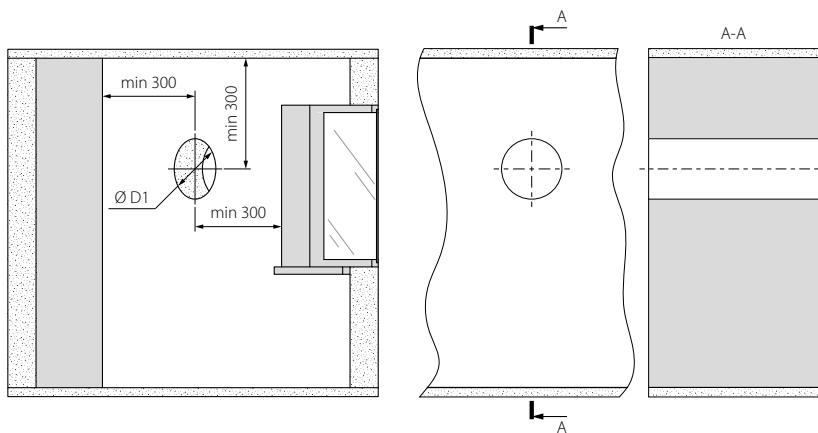
2. Setzen Sie das Lüftungsrohr so in das Loch ein, dass seine Schnitte mit der Außen- und Innenfläche der Wand ausgerichtet sind. Verwenden Sie zur Erleichterung der Montage die mitgelieferten Schaumstoff-Keile.
