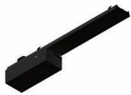
SITECO Connect IP Gen.1, Schieneneinsatz, IP LAN-Anschluss, mit Stecker, 6polig, mit Phasenwahl, Netzanschluss: 230V, AC, 50Hz, Adapter, aus Stahlblech, bandlackiert, tiefschwarz (RAL 9005), Länge: 450mm, Breite: 64mm, Höhe: 38mm, Schutzart (gesamt): IP40, Schutzklasse (gesamt): SK I (Schutzerdung), Prüfzeichen: CE, UKCA, Verpackungseinheit: 1 Stück
