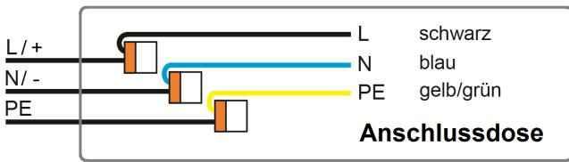
Nach dem Anschluss an das Netz wird die Leuchte in Betrieb gesetzt. Bei DC-Speisung ist auf die richtige Polarität zu achten. Bei unsachgemäßem Anschluss kann die Elektronik beschädigt werden.
