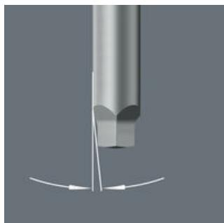
V-Bits weisen ein konisches Profil auf. Die dadurch erzeugte Klemmkraft hält Robertson-Schrauben sicher auf der Werkzeugspitze. Ideal beim Verschrauben an schwer zugänglichen Stellen.
