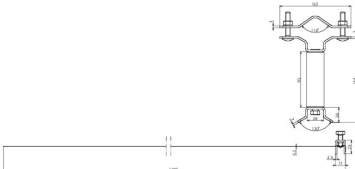
Mit zusätzlichem langen Distanzstück, um Halterungen von Sektorantennen am Mast auszugleichen.
