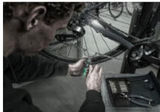
Mit Kettennieter und -halter mit auswechselbarem Nietstift zum Öffnen und Schließen von Fahrradketten. Geeignet für Single-Speed Ketten, bis 12-fach.
