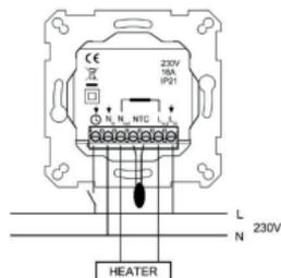
Positionnez maintenant le thermostat et fixez-le avec 2 vis dans le boîtier mural. Montez les pièces du couvercle, fixez-les avec la vis et enfin, poussez le bouton rotatif à la bonne position.
