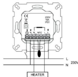
Posizionare ora il termostato e fissarlo con 2 viti nella scatola di montaggio a muro. Montare le parti di copertura, fissarle con la vite e infine spingere la manopola nella posizione corretta.
