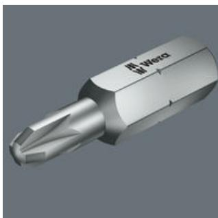
Bei den Bits mit reduziertem Schaftdurchmesser ist gewährleistet, dass Schrauben in die Oberfläche versenkt werden können, ohne die Oberfläche zu beschädigen. Diese Anwendung ist speziell im Trockenbau erforderlich.
