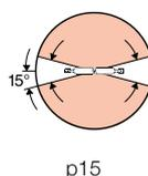
Die angegebenen Brennstellungen müssen eingehalten werden. Nichtbeachtung kann z. B. zum vorzeitigen Ausfall der Lampen führen. Es bedeuten:
