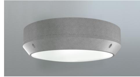
In robuster Ausführung und zeitlosem Design, geeignet für Innen- und Außenanwendung. Die Notlicht-LED kann bei der Montage werkzeuglos ausgeklappt werden um z.B. bei Wandmontage die Flucht- und Rettungswege optimal zu beleuchten. Über den von außen nicht sichtbaren Bewegungsmelder wird das Allgemeinlicht unabhängig vom Notlicht geschaltet.
