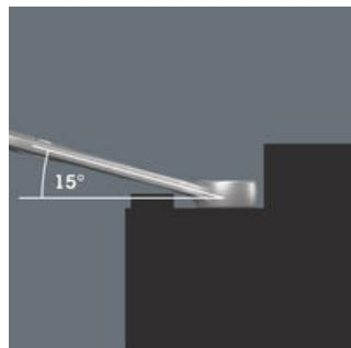
Die Ringseite ist um 15° zur Werkzeugachse abgewinkelt, um Verletzungen vorzubeugen.
