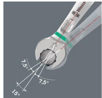
Durch die um 7,5° geschwenkte Maulseite, Doppelsechskantgeometrie und eine angepasste Anwendungsweise (Ansetzen - Schrauben - Drehen - erneut Ansetzen - Schrauben - Drehen usw.) können auch Schraubsituationen gelöst werden, die weniger als 30° Schwenkwinkel zulassen.
