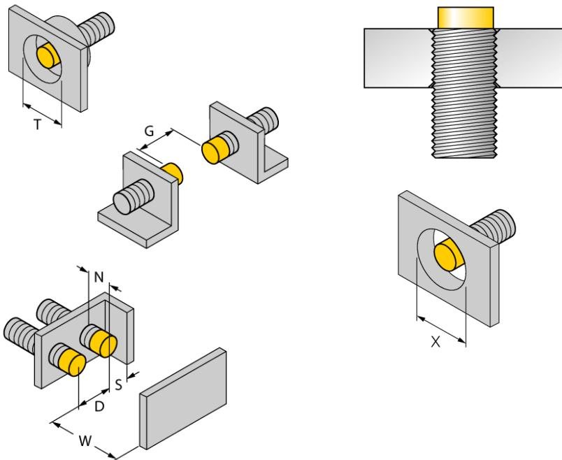
Bei allen nichtbündigen *uprox®+* Gewinderohrschaltern ist ein Einbau bis zur Rohrkante erlaubt. Ein sicherer Betrieb ist hierbei mit einer maximalen Reduzierung des Schaltabstandes von 20% gewährleistet.
