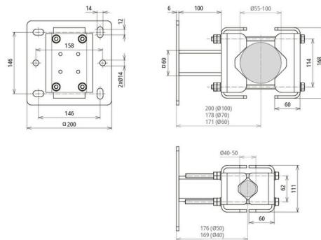
Mastbefestigung für Wandmontage aus St/tZn für die waagrechte Montage. Zum Befestigen größerer Fangmaste Ø40-50 mm (hochkant) und Ø55-100 mm (quer) mittels Gewindestangen am zu schützenden Aufbau oder an der Wand. Mit langlöcher zur Montage versehen.
