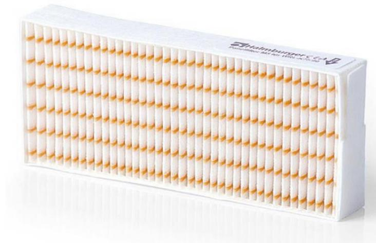
Original-Ersatzfilter für dezentrale Wohnraumlüftungsgeräte WRL-K75 und WRL-K90 Typ: WRL-KF5, Filterklasse M5 (DIN 779:2012), bzw. ISO ePM10 65%/ISO ePM2,5 30% (ISO16890), Rahmen aus PET, Filtermedium PP plissiert, mit Auszugslasche, für Abluft und Außenluft, Abmessung: 151x65x25mm
