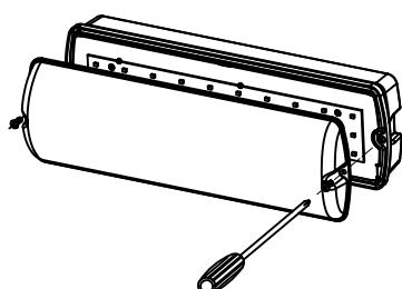
Entfernen Sie die Schrauben mit einem Schraubendreher und nehmen Sie dann die Gehäuseabdeckung ab.
