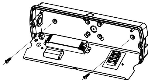
Befestigen Sie die Leuchte mit Hilfe der Schrauben an der gewünschten Position.
