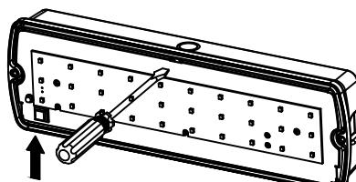
Stecken Sie den Schlitz-Schraubendreher in die Öffnung oberhalb der Mitte und heben Sie das Trägermodul auf.
