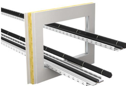
2. Durchbruch umlaufend mit Kreppband mit 20 mm Abstand zur Kante abkleben. Kabel mit FLAMMOTECT-A oder BMA/BMS/BMK beschichten.
