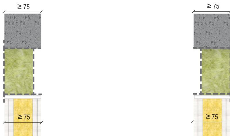
— — — = Beschichtung/Verklebung mit FLAMMOTECT-A oder BMA/BMS/BMK (Trockenschichtdicke  $\geq 1,5$  mm)
