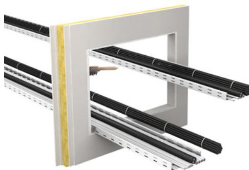
3. Mineralfaserplatte zuschneiden. (Ausschnitte für die Durchführungen herstellen). Kanten der Mineralfaserplatte mit FLAMMOTECT-A oder BMA/BMS/BMK einstreichen und Platte stramm sitzend einbringen.
