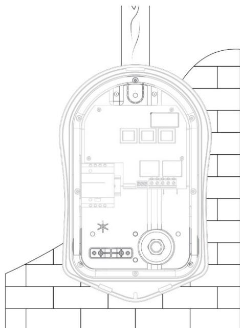
Markieren Sie mit Hilfe der zappi-Schablone die Bohrlöcher für die Montage. Für die Befestigung an einer Backsteinwand verwenden Sie die oberen und 2 unteren Löcher (links/rechts). Verwenden Sie die 2 vertikalen Löcher sowie das obere Loch, wenn Sie das Gerät an einem Pfosten oder Balken befestigen.
