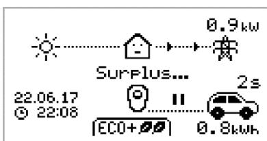
Es ist genügend Überschuss vorhanden und zappi beginnt mit dem Laden des Fahrzeugs. Ein entsprechender Timer kann in den Ladeeinstellungen eingestellt werden (nur im ECO+-Modus)
