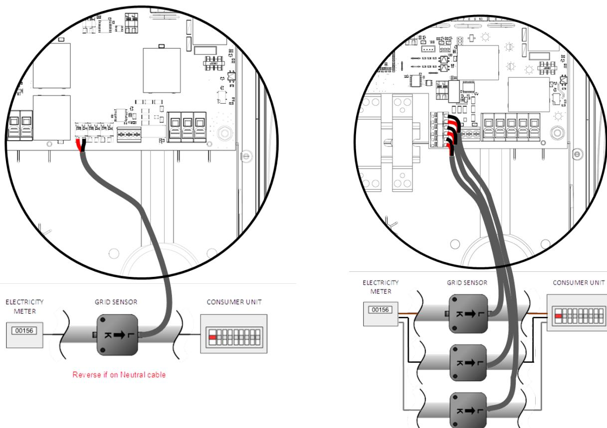
**EINPHASIG:** Eine CT-Klemme muss um den stromführenden Zähleranschluss gelegt werden, wie oben gezeigt, wobei der Pfeil in Richtung der Verbrauchereinheit zeigt.
