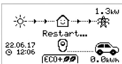
zappi führt eine Neustart-Sequenz durch.
