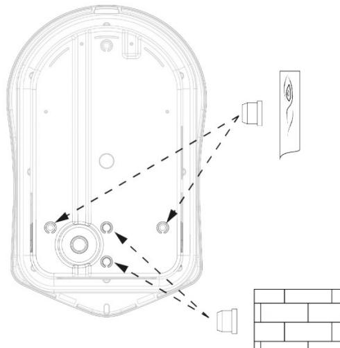
Um die IP-Schutzklasse des Geräts zu erhalten, müssen Sie die nicht verwendeten Löcher mit den mitgelieferten Stöpseln versehen.
