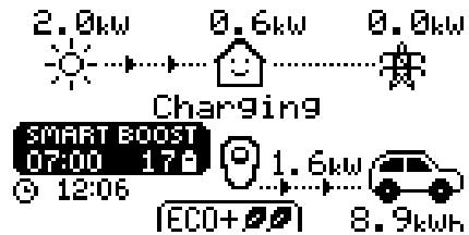
3. zappi testet dann das Fahrzeug für ein paar Sekunden, um die maximale Ladeleistung zu ermitteln.
