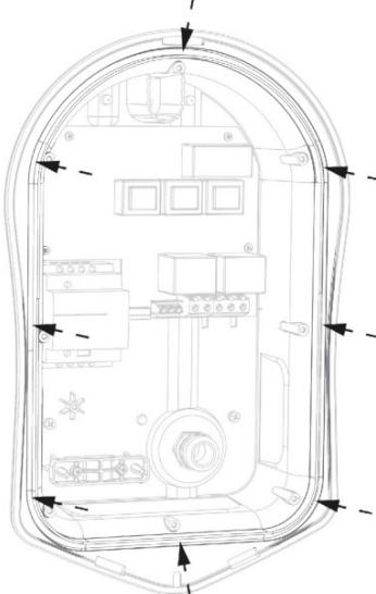
Befestigen Sie das Gerät mit dem mitgelieferten Montagesatz an der Wand. Stellen Sie sicher, dass die Tüllen verwendet werden, um die IP-Sicherheit zu gewährleisten.
