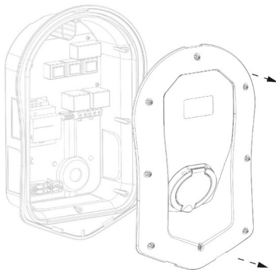
Entfernen Sie alle 8 Schrauben aus dem Gehäuse und heben Sie es vorsichtig ab.
