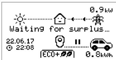
zappi wartet auf eine ausreichende Überschussenergiemenge aus dem Mikroenergiesystem. Dieser Bildschirm wird im ECO+ Modus angezeigt, da nur in diesem Modus der Ladevorgang gestoppt wird, wenn nicht genügend Überschussenergie vorhanden ist.
