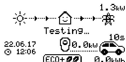
4. Der Boost wird zum spätestmöglichen Zeitpunkt gestartet, um die eingestellte Energiemenge zu erreichen. Wenn der aktuelle Ladevorgang bereits genügend Energie gespeichert hat, wird der Boost nicht benötigt und ist daher nicht aktiv.
