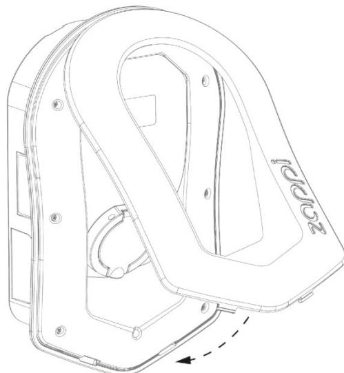
Decken Sie das Gehäuse ab und stellen Sie sicher, dass alle Kabel im Inneren des Geräts ordnungsgemäß befestigt sind.
