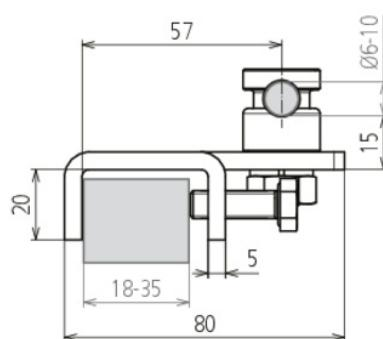
Schwere Ausführung; für den Anschluss an Stahlkonstruktionen.
