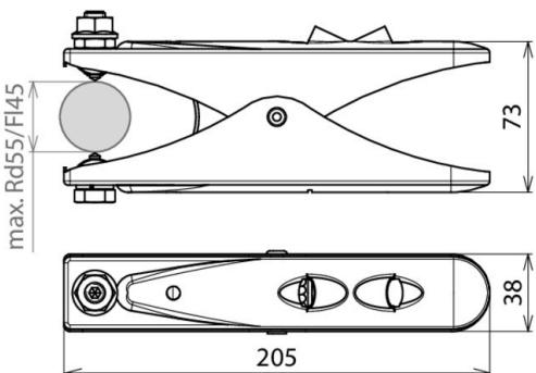
Zwei Messingbacken mit Stahlspitzen (Werkst.-Nr. 1.4104)
