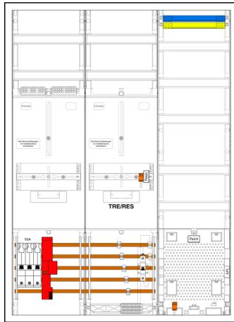
**3HZ731TAPZ50B6ÜS, 1 TRE, 1 VAPZ incl. APL, TIEHZ, SLS 50A, ÜSS, 2 PPV, 1 PL150**
