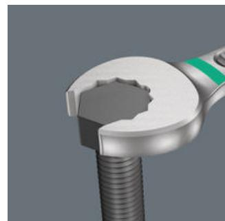
Der Ringmaulschlüssel Joker 6003 mit seiner besonderen Maulgeometrie - eine um 7,5° geschwenkte Maulseite und die Doppelsechskantgeometrie - verdoppelt die Ansetzmöglichkeiten bei wiederholter 180°-Drehung des Schlüssels um die Längsachse. Muttern bzw. Schraubenköpfen können alle 15° "gepackt" werden. Den jeweiligen Ansetzpunkt findet der Joker 6003 nach jedem Wenden sozusagen von selbst.
