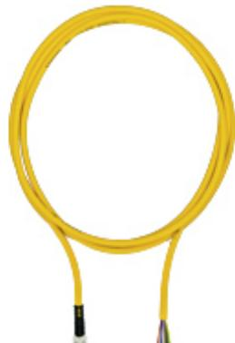
Anschlusskabel, PUR, Gelb RAL1003, Schleppkettenfähig, 8-polig, Buchse gerade M8, auf offenes Leitungsende, A-kodiert, Kabellänge: 5 m
