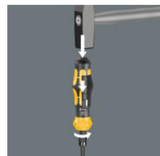
Der Hammerschlagimpuls wird bei zugeschalteter Schlagschraubfunktion in eine Drehbewegung mit einem Lösemoment von bis zu 25 Nm umgesetzt. Die Kraftübertragung erfolgt verlustfrei über eine durchgehende Klinge.
