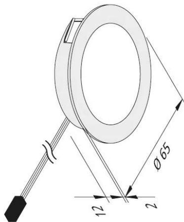
bei Dämmung Abstandshalter min. 50 mm verwenden
