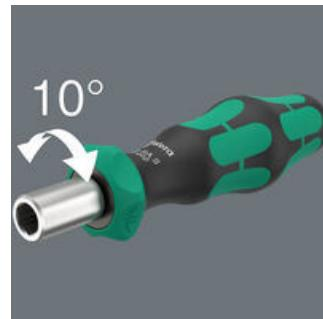
Die integrierte Ratsche mit Feinverzahnung (36 Zähne) und einem Rückholwinkel von 10° vereinfacht und beschleunigt das Schrauben ohne mühsames Neuansetzen.
