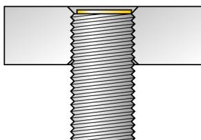
Bei allen bündigen uprox®+ Gewinderohrschaltern ist ein überbündiger Einbau erlaubt. Bei einem zurückgesetzten Einbau von einer halben Gewindeumdrehung ist ein sicherer Betrieb gewährleistet.
