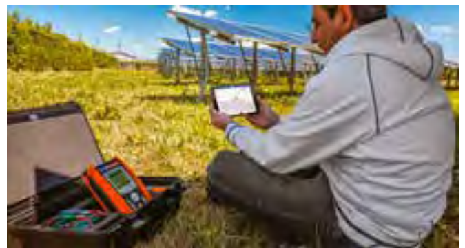
Auswertung und Protokollerstellung der U-I Kennlinie mit Ihrem Smartphone oder Tablet und der App HTANALYSIS™
