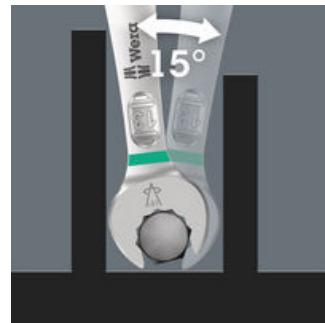
Der Doppelmaulschlüssel Joker 6005 mit seiner besonderen Maulgeometrie - eine um 7,5° geschwenkte Maulseite und die Doppelsechskantgeometrie - verdoppelt die Ansetzmöglichkeiten bei wiederholter 180°-Drehung des Schlüssels um die Längssachse. Muttern bzw. Schraubenköpfe können alle 15° "gepackt" werden. Den jeweiligen Ansetzpunkt findet der Joker 6005 nach jedem Wenden sozusagen von selbst.
