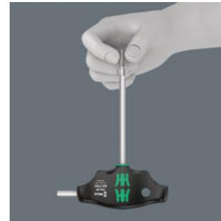
Die Klemmung der Innensechskantschraube auf der Werkzeugspitze wird durch eine federnde Kugel gewährleistet. Besonders hilfreich in schwer zugänglichen Arbeitsbereichen, wo man die zweite Hand nicht zum Festhalten der Schraube nutzen kann.
